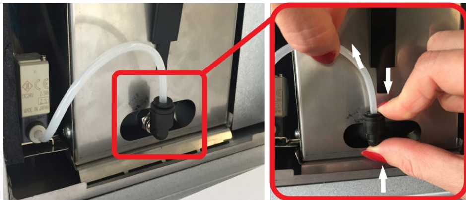
7 pav. Vandens vamzdelio atjungimo schema
