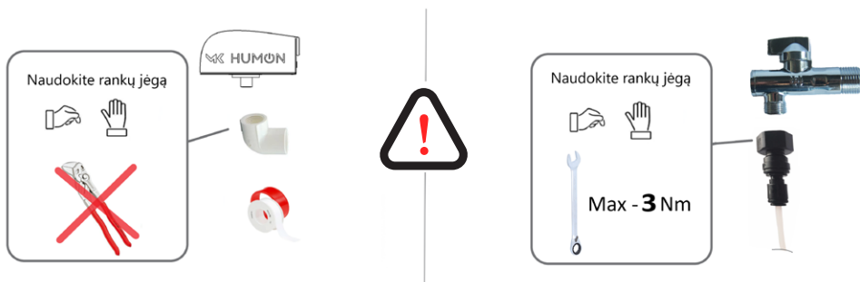
6 pav. Vandens pajungimo schema
